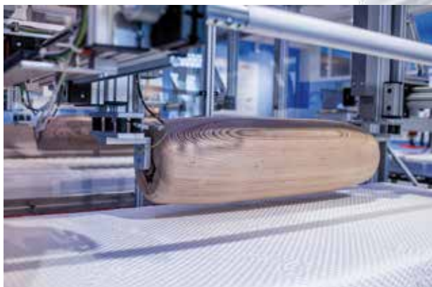
Testovanie mechanickej odolnosti. Simulácia životnosti matraca maximálnym zaťažením v najexponovanejšej časti matraca valcovaním.
